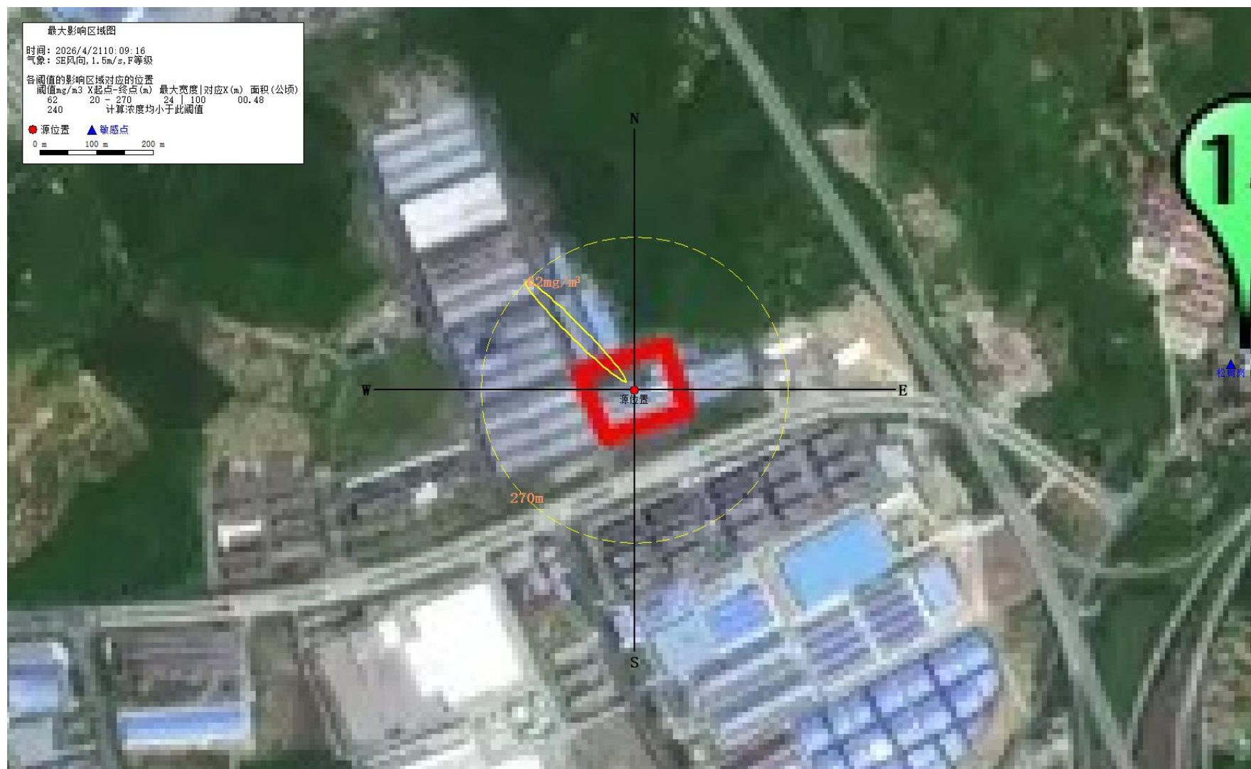
图 6.7-3 F类稳定性、风速 1.5m/s 情况下硝酸包装桶倾倒泄漏挥发毒性气体硝酸危害区域图
