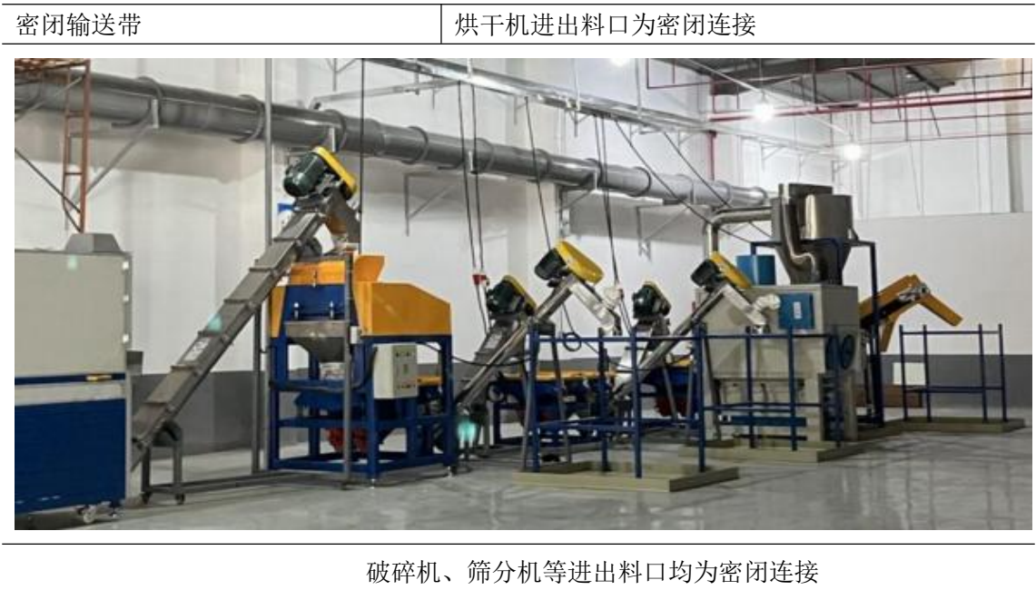
图 6.2-2 项目密闭设备结构示意图（同类型项目）
