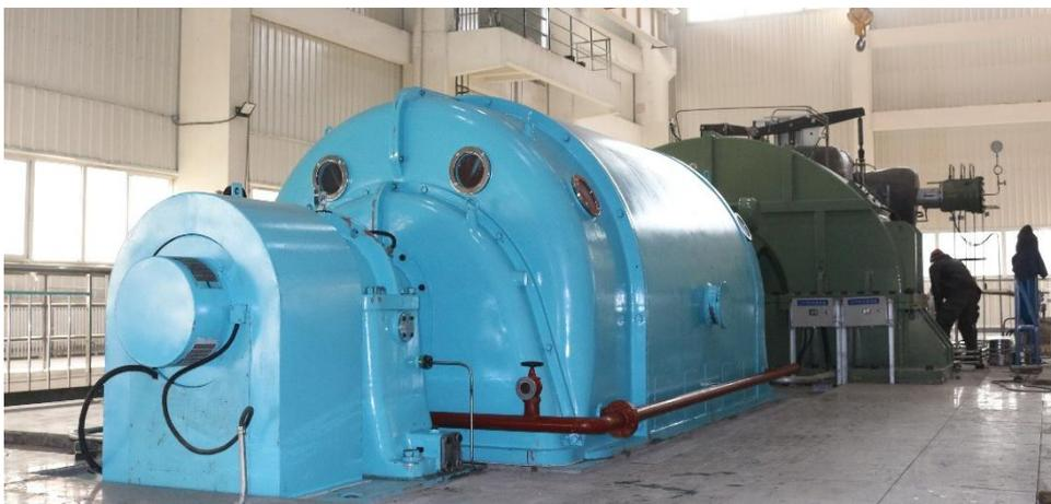
图3 生物质 30MW 抽凝机
